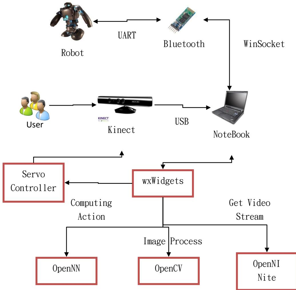
圖 1-3 主程式系統架構圖表
