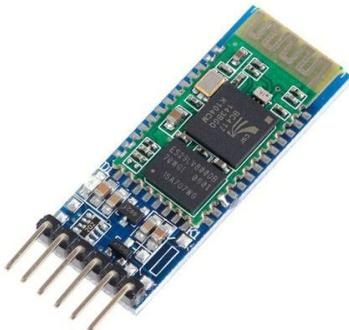
我們選用藍芽作為將指令送給機器人的傳輸方式，因為我們的系統必須是在可以看得到機器人實體的情況下操作，因此只需要在幾十公尺內的無線傳輸技術即可。
