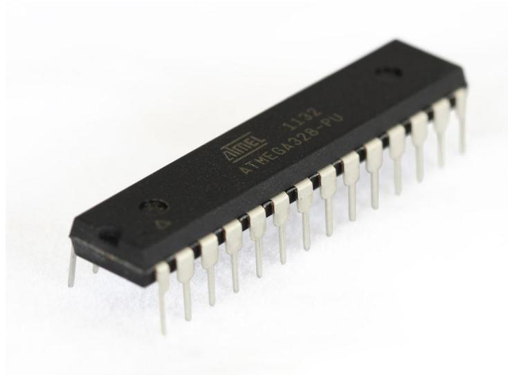
圖 6-3 ATmega328P-PU
