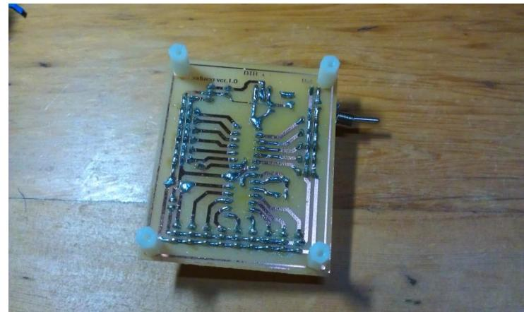
圖 6-8 感光電路板成品
